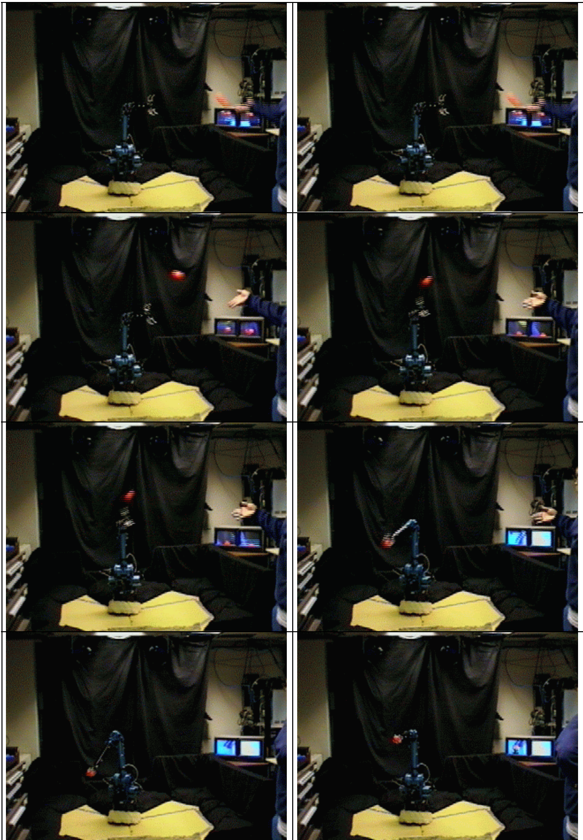
Figure IV-11 : Capture d'une balle par un bras-manipulateur couplé à deux caméras (d'après Hong et Slotine, 1995 ; la lecture se fait de haut en bas et de gauche à droite).
